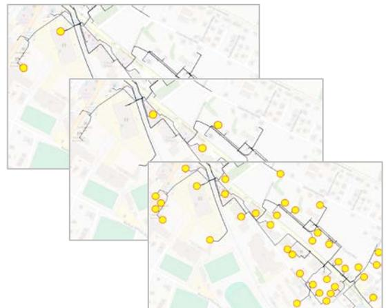
Análisis del módulo Hosting Capacity - Diferentes niveles de penetración de las estaciones de carga en una red de distribución
